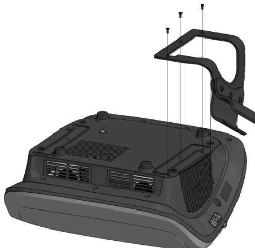
Rysunek 6-2 Montaż uchwyty aplikatora
